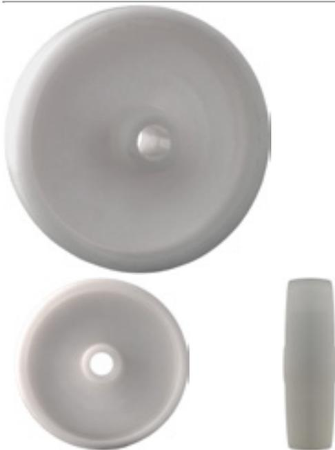
**Polypropylen**-Räder verfügen über eine hohe Tragkraft und über gute Fahreigenschaften auf ebenen Böden bei einem niedrigen Rollwiderstand. Polypropylen ist bei Raumtemperatur gegen Fette und fast alle organischen Lösungsmittel beständig und zudem bruchsicher.
